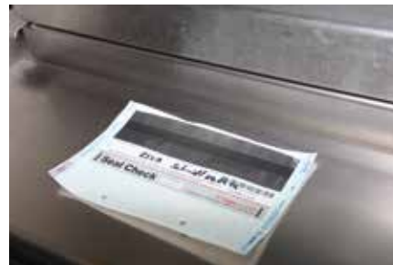
Seal-Check-Test: Funktionsbeurteilung der Siegelnaht
