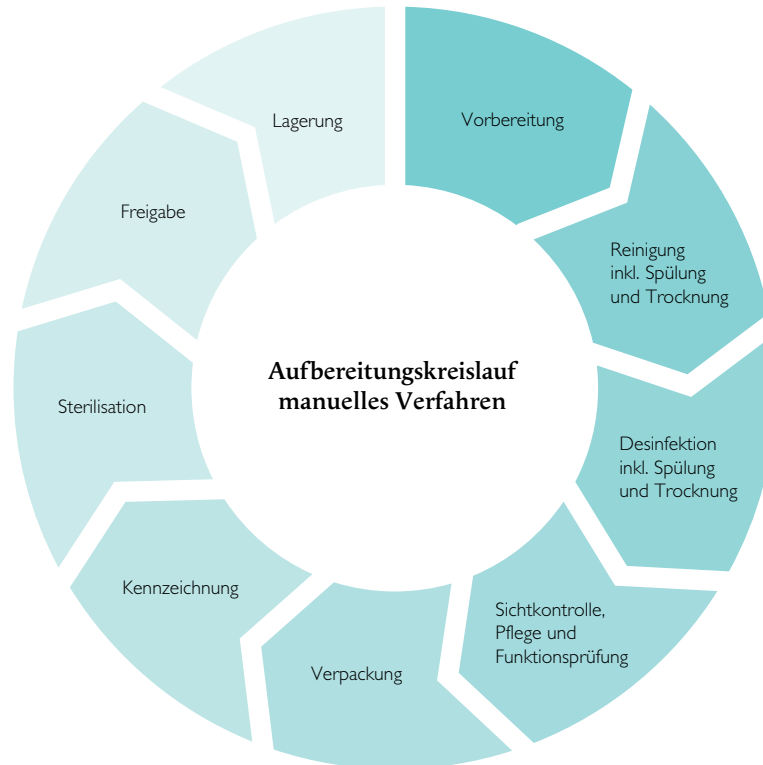
Abbildung 3: Aufbereitungskreislauf manuelles Verfahren
